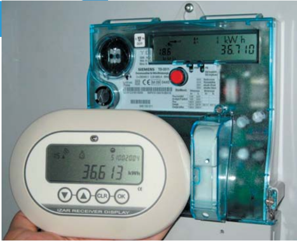
Compteur déployé par l'entreprise locale de distribution EBM en Alsace, avec un afficheur déporté.
